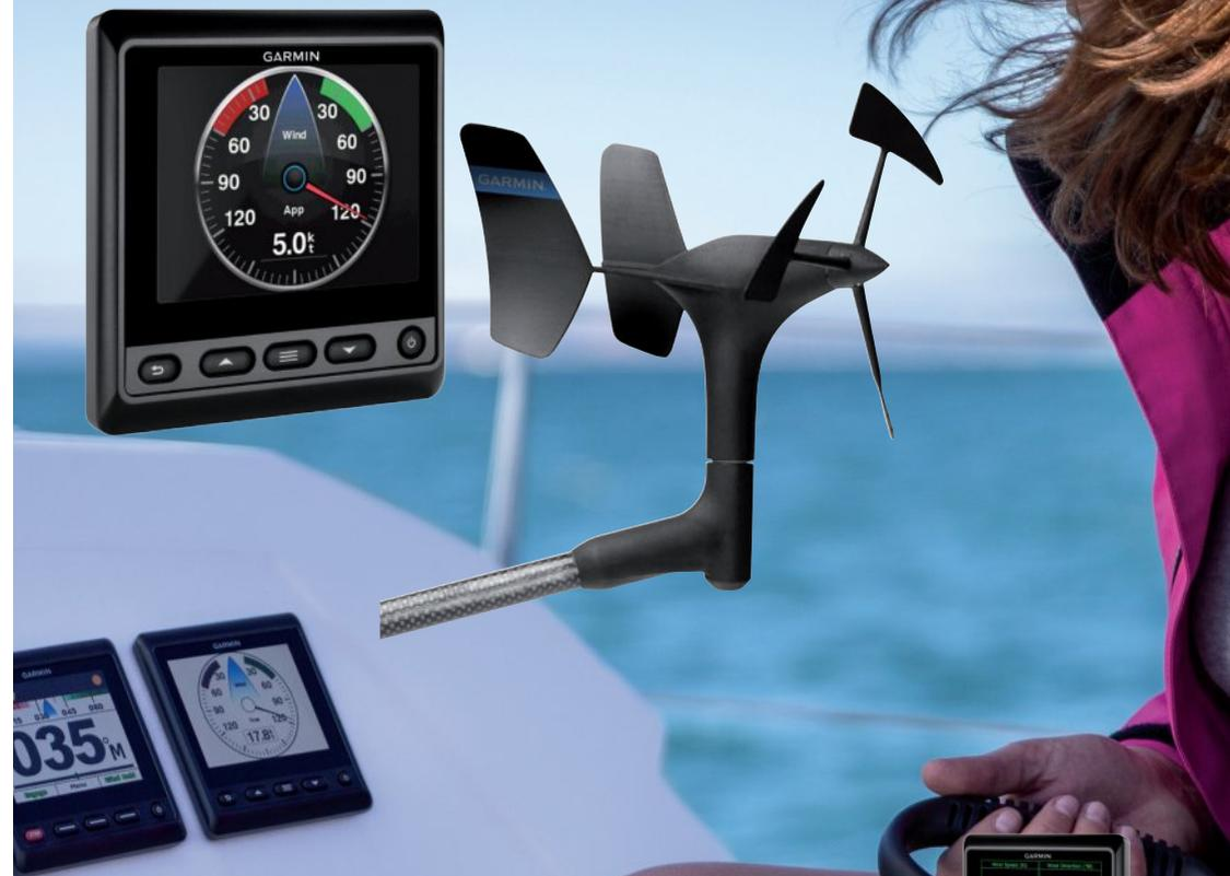
La girouette anémomètre gWind™ sans fil est une solution simple et facile à installer. Elle permet d'éviter d'avoir à acheminer des câbles jusqu'en haut du mât. La girouette communique avec le boîtier de connexion WSI par ondes radio. Ce dernier envoie les informations de vent au module GND 10 qui permet de faire communiquer aisément l'ensemble des appareils connectés au réseau NMEA 2000.
